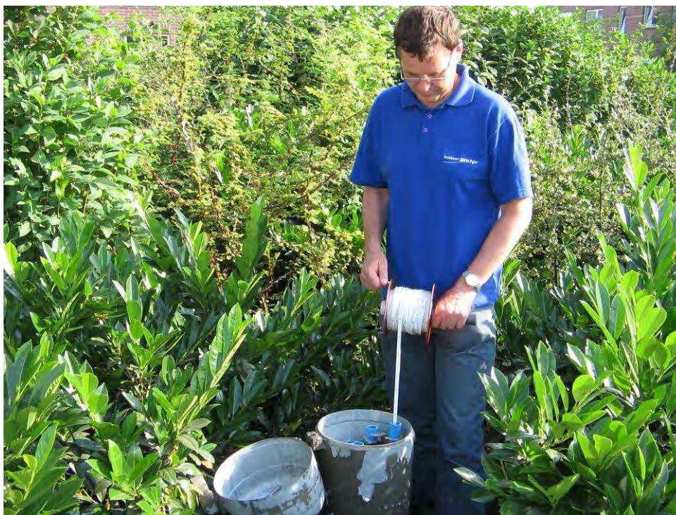
Foto 16-1 Het meten van een grondwaterstand met behulp van een peillint (foto Carl van Rosmalen, Brabant Water)
