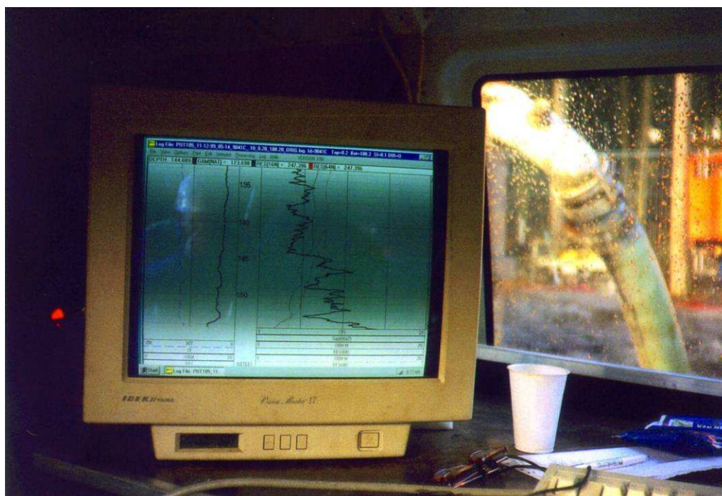
Foto 11-3 De resultaten van een geofysische boorgatmeting worden in het veld direct gepresenteerd (C. van Rosmalen, Brabant Water)
